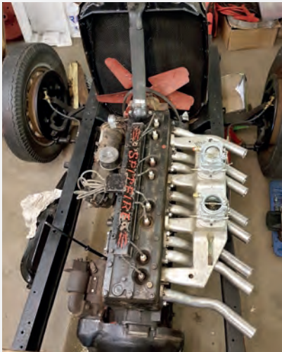
Her er 323-kubikktommars motoren på plass pr hausten 2020 med eit eldgammalt to-forgassar innsug, tenningsystem merka Spitfire og svært så korte eksosrør omtrent som på eit Spitfire jagarfly.
