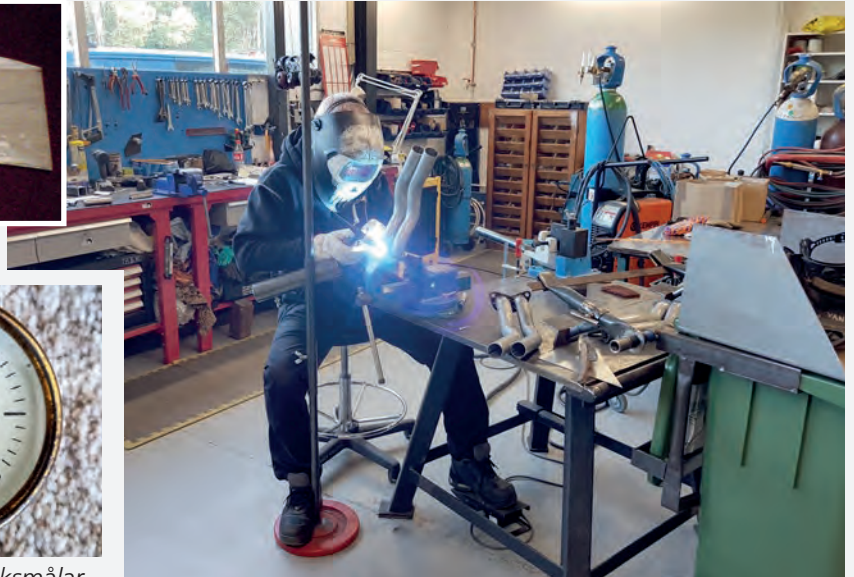
For å få fine sveisar på stubbeeksosen fekk eg Jørgen Vangen til å TIG-sveise røra til flensane.
