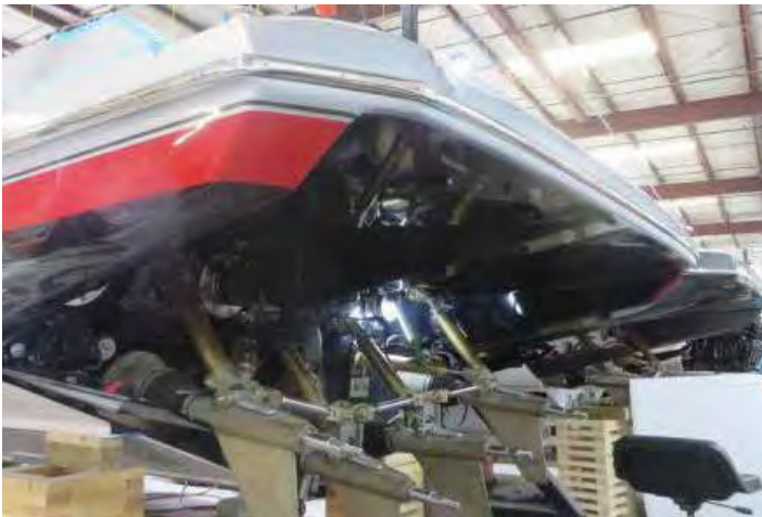
For de av dere som har greie på båter og ser nøye etter, ser at her er 4 stk. Arneson drev for overflatepropeller. Cummins kvartett.
