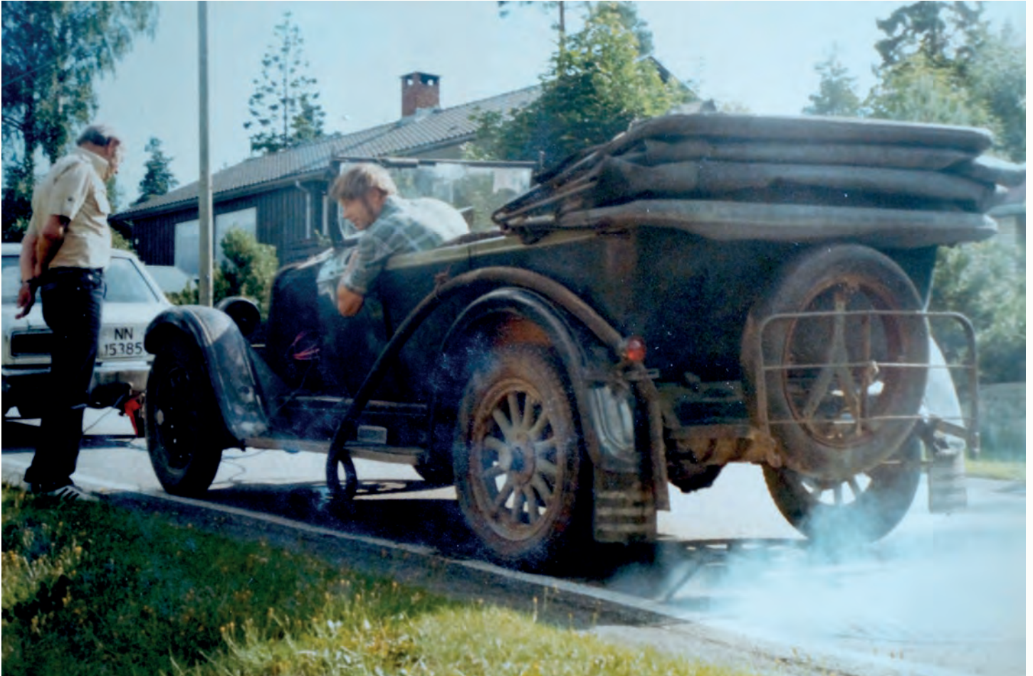
Manglande eksosrør var for anledningen erstatta med gummislange frå ein parafinbil. Blårøyken indikerte at det var behov for motoroverhaling.
