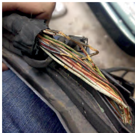
Typisk 90-tals bil med elnett isolasjon i full oppløysing. Heldigvis sluttar som regel bilane å gå før dei brenn.
