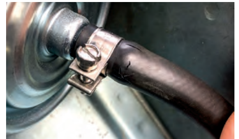
Moderne bensinslange som sprekk opp og kollapsar etter få månaders bruk.
