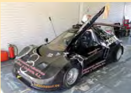
Spansk Short Car-variant, en lukket Demon Car, med 600 ccm Yamaha-snelle. Den gikk som et lite h...
