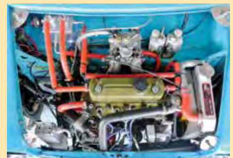
Austin MK! Mini Cooper S med 1380 ccm-motor, maks boring av hva som regnes som forholdsvis holdbart. Slangesalaten er vel ikke helt historisk.
