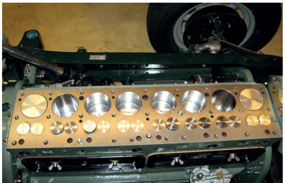
Nybora motor med nye ventilar på plass i understellet.
