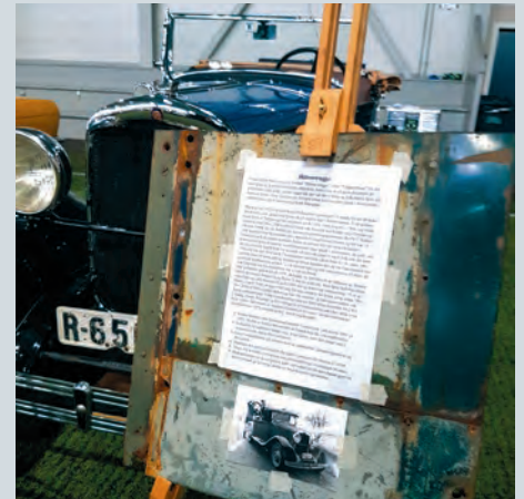
Info-plakat må til. Lerretet er avkappa frå torpedoen, komplett med 4 ulike fargar rust og pånagla reperasjon i alu.
