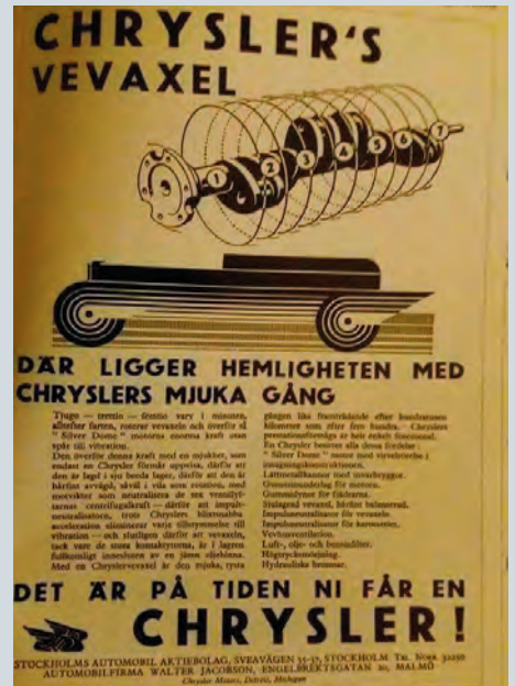
Chrysler var ein av dei billegare bilane på marknaden som leverte 6 sylindra motor med 7-lagra veiv.
