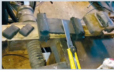
Dyre gummiklossar til hjulopphengnet frå Steele i USA hadde like elendig passform som dei rimelege eg kjøpte i Australia. Linoleumskniven blei flittig brukt.
