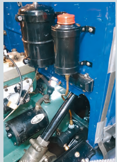
Med karosseriet tilbake blei oljefilter (svært avansert for 1929) og bremsevæskebeholdaren montert.
