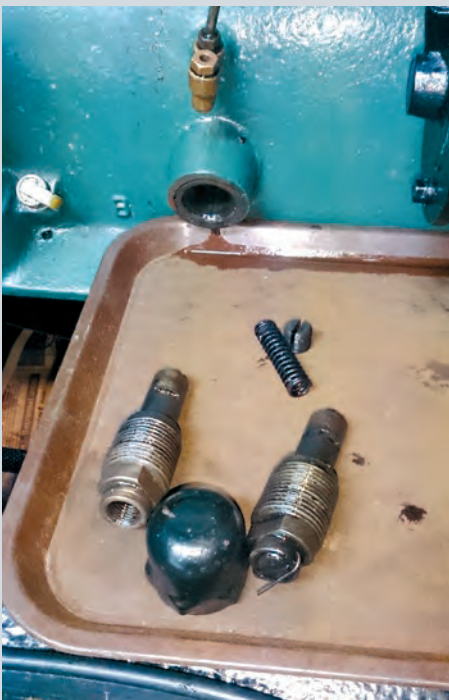
Eg sprengte to stk oljetrykksmålar før eg forstod at trykkregulatoren hadde hengt seg opp. Då var det kjekt å ikkje ha kasta den øydelagde motoren frå delebil nr 4.
