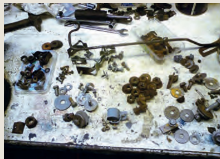
Grundig sorterte skruer blei fotografert slik dei høyrde saman før galvanisering, slik at dei kunne plasserast korrekt etterpå.
