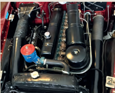
Fireball toppventilert rekkeåttar er eit imponerende syn.
